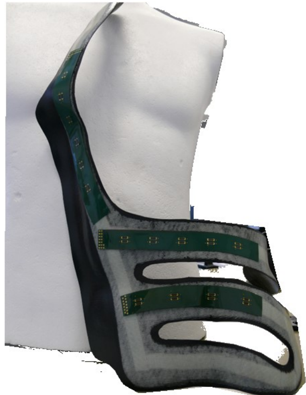
Abbildung 5 Flexible Sensorstreifen mit gedruckten DMS-Strukturen auf Polyimidleiterplatten vor einem Modelloberkörper
