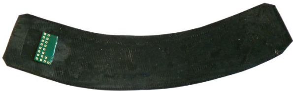
Abbildung 7 In Carbonverbundmaterial integrierte DMS-Sensorstreifen.
