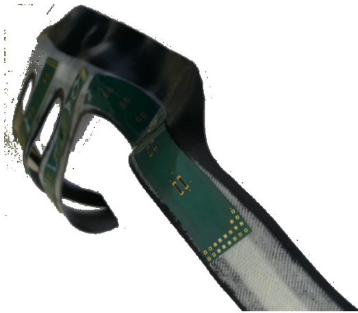
Abbildung 6 Flexible Sensorstreifen mit gedruckten DMS-Strukturen auf Polyimidleiterplatten ohne Hintergrund
