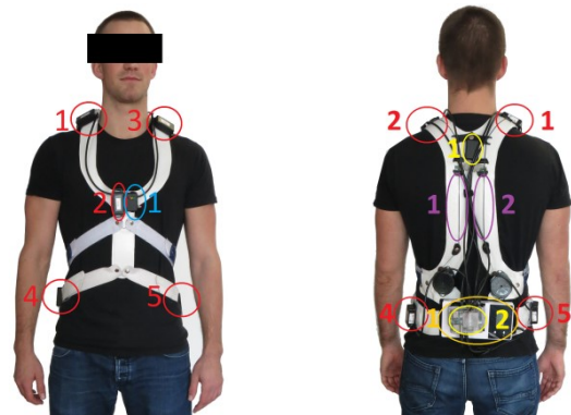
Abbildung 2 Prototyp mit fünf IMUs (rot), zwei DMS (lila), einem Akku mit Anzeige (orange), dem Feedbackmodul (blau) und den verarbeitenden Einheiten (gelb)
